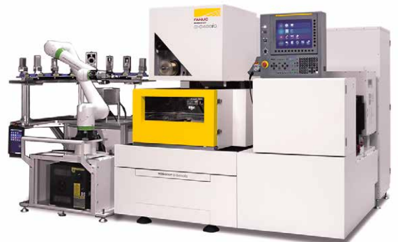
采用了机器人的工件装卸单元例
